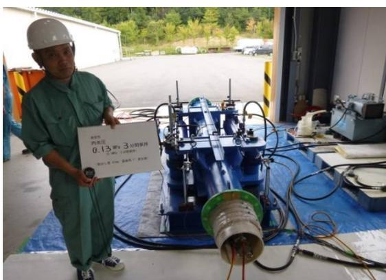
写真 2 - 1 拔出し長 1.5%(47mm) + 屈曲 1° + 内水圧 0.1MPa
