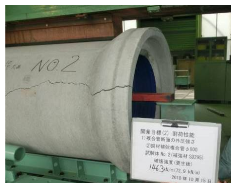
補強鋼材 SD295 による更生管
