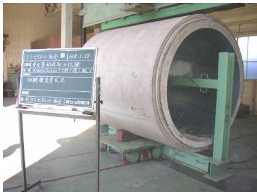
円形管呼び径 1800 更生管 (左: 載荷前, 右: 載荷後)
