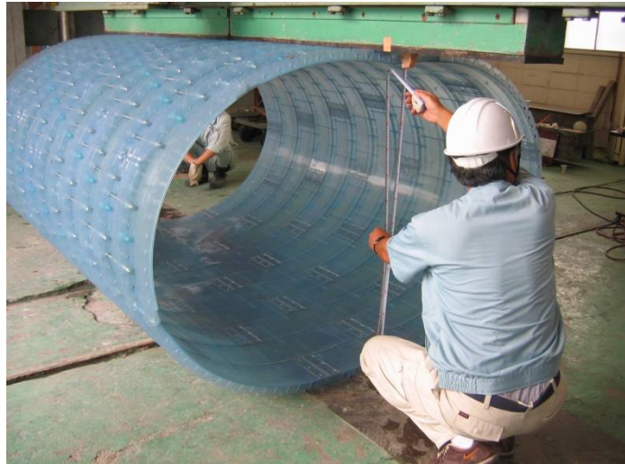
載荷装置による3Sセグメント変形状況
