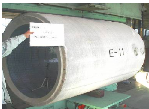
円形管呼び径 1500 更生管 (左: 載荷前, 右: 載荷後)
