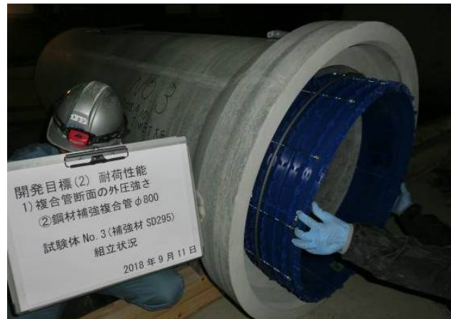
写真-3.1.2 補強鋼材 SWM-C 配置状況 写真-3.1.3 補強鋼材 SD295 配置状況
