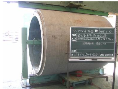
円形管呼び径 1800 更生管 (左: 載荷前, 右: 載荷後)
