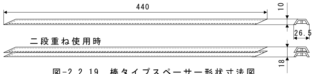
図-2.2.19 棒タイプスペーサー形状寸法図
