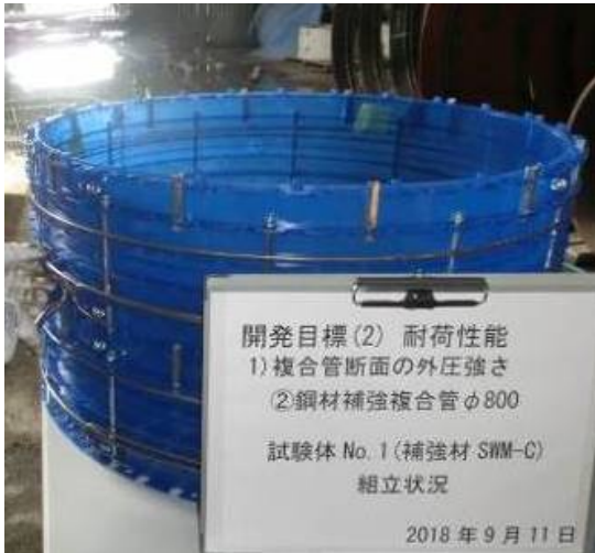
写真-3.1.2 補強鋼材 SWM-C 配置状況 写真-3.1.3 補強鋼材 SD295 配置状況
